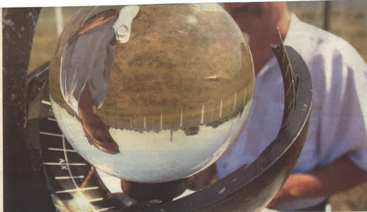
Aparatul din imagine se numește heliograf și măsoară durata de strălucire a Soarelui într-o zi Foto: Tudor Vintiloiu
